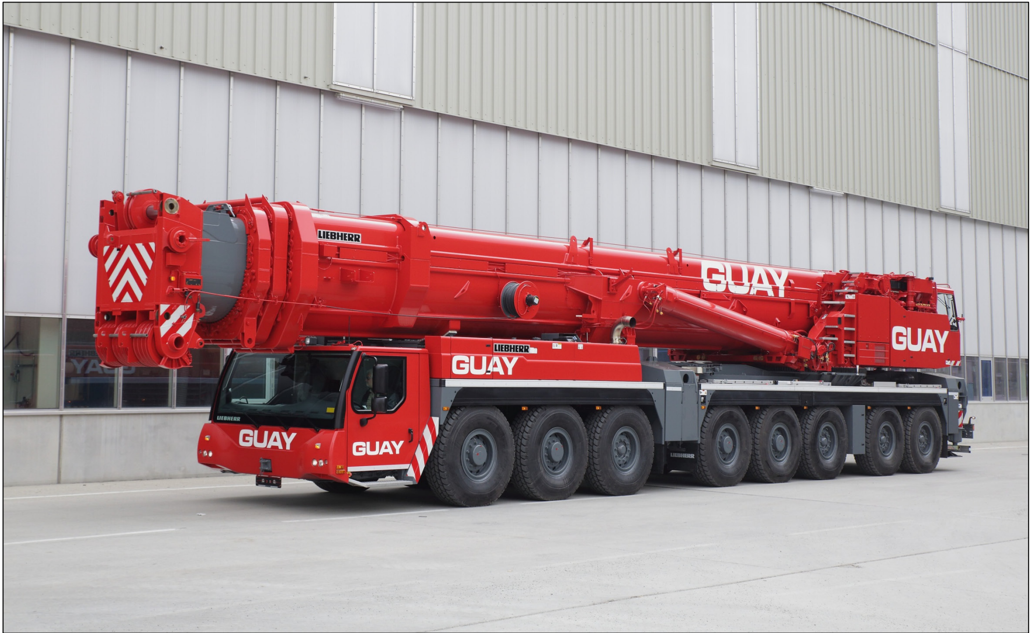
GRUE TOUT-TERRAIN DE 650 TONNES, LIEBHERR LTM1500-8.1
