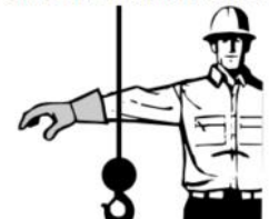
Figure I.22 OUVRIR LA BENNE PRENEUSE
