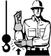
Figure I.6 UTILISER LE TREUIL AUXILIAIRE
